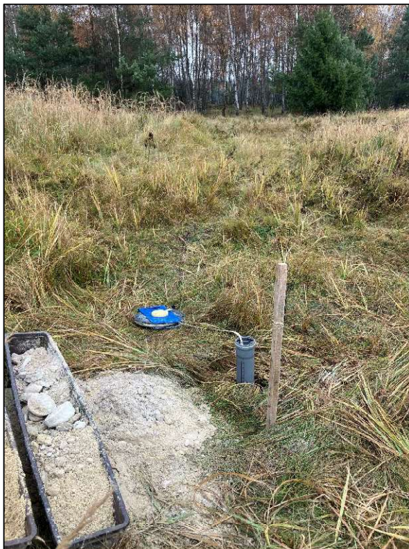
Obr. č. 8: Vsakovací zkouška na sondě PS-2
