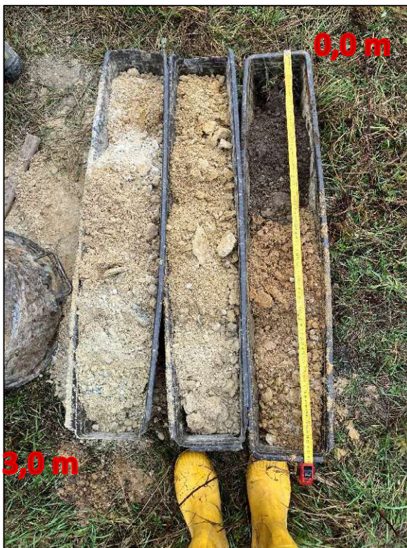
Obr. č. 6: Profil sondy PS-3 (0,0 – 3,0 m p.t.)
