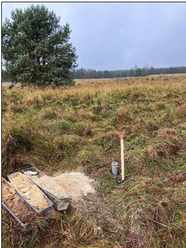
Obr. č. 7: Vsakovací zkouška na sondě PS-1
