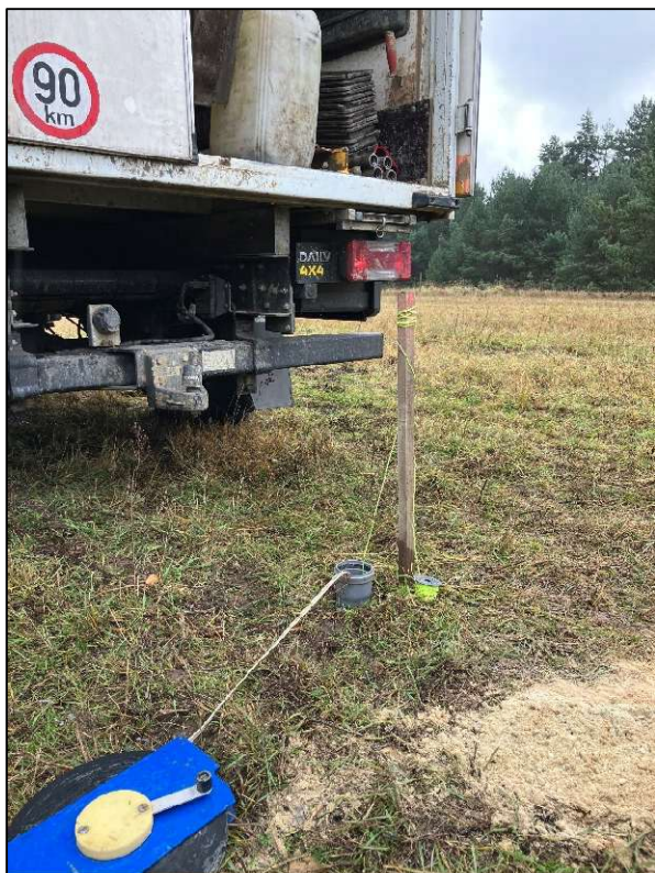
Obr. č. 9: Vsakovací zkouška na sondě PS-1
