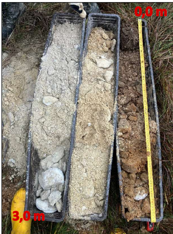
Obr. č.2: Profil sondy PS-1 (0,0 – 3,0 m p.t.)
